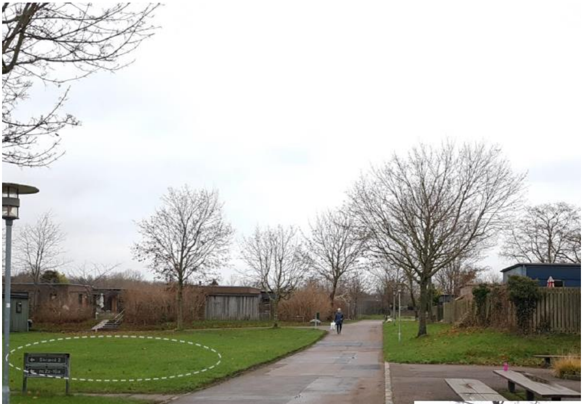
Figur 13: Eksempel på grønt område i en boligbebyggelse, hvor der kun skal mindre terrænreguleringer til at skabe et forsinkelsesvolumen og lede vandet ud på det grønne areal under skybrud
